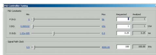
Рис. 7. «Бегунки» для точной настройки — удобный инструмент для настройки систем в реальном масштабе времени
