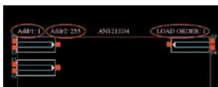
Рис. 1. Конфигурирование логических адресов ADDR1 и ADDR2 в программе AnadigmDesigner2
