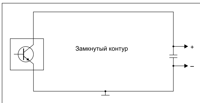
Рис. 6. Возникновение замкнутого контура, образованного шиной «земли» и питания
