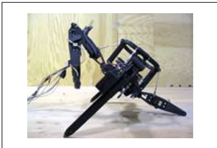
Рис. 7. Четвероногий робот, управляемый с помощью нейронной сети
