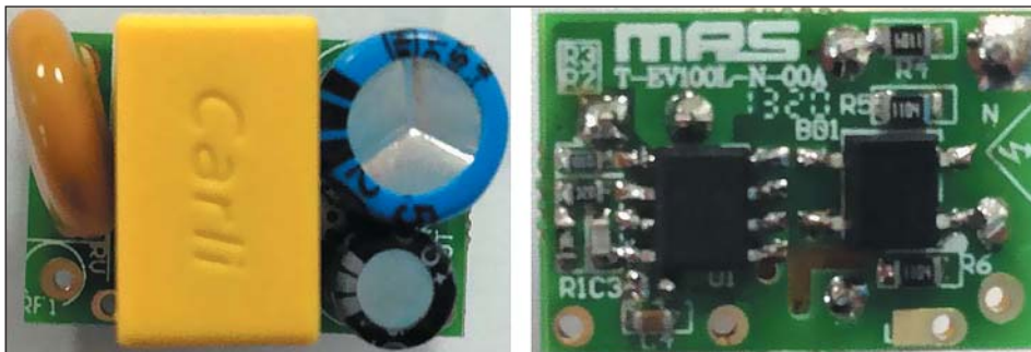
Рис. 6. Внешний вид ИП дежурного режима на базе микросхемы MP100L (габаритные размеры 29×19×18 мм)
