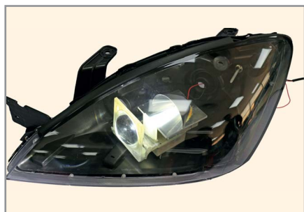
Рис. 4. Макет фары автомобиля с источником света на основе светодиодной продукции SemiLEDs
