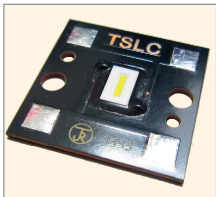
Рис. 5. Светодиодный модуль для фары головного света автомобиля на основе светодиодной продукции SemiLEDs
