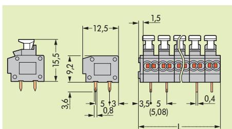
Диаметр отверстия под вывод: 1<sup>+0.1</sup> мм
