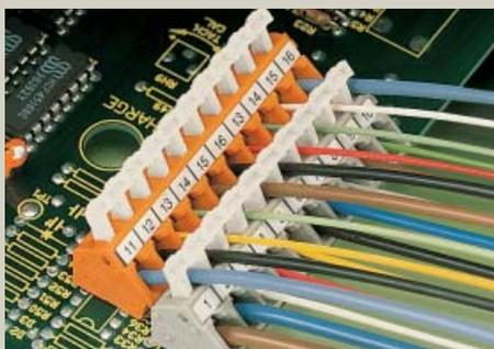
Возможное размещение проводников при шахматном
