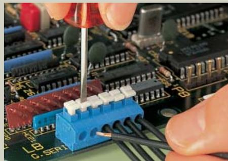
Подключение/отключение многожильных проводников с обжатými жилами с использованием нажимной кнопки
