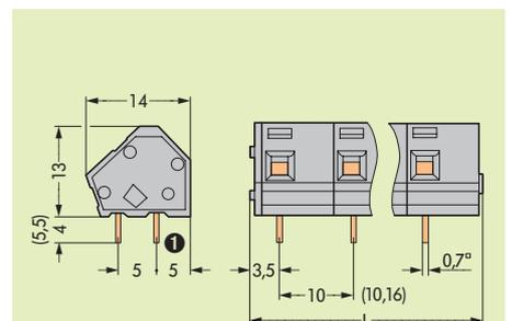
Диаметр отверстия под вывод:  $1.1^{+0.1}$  мм
