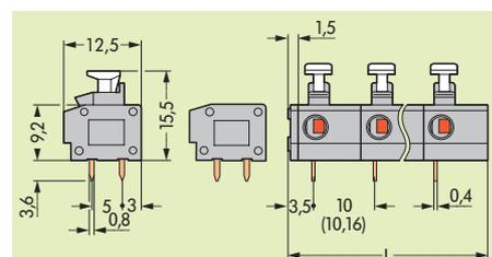
Диаметр отверстия под вывод: 1<sup>+0.1</sup> мм
