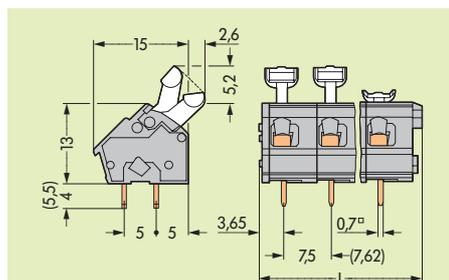
Диаметр отверстия под вывод: 1.1<sup>+0.1</sup> мм
