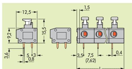
Диаметр отверстия под вывод: 1<sup>+0.1</sup> мм
