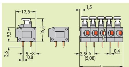
Диаметр отверстия под вывод: 1<sup>+0.1</sup> мм
