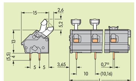
Диаметр отверстия под вывод: 1.1<sup>+0.1</sup> мм
