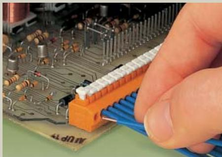
Подключение проводников с использованием нажимной кнопки
