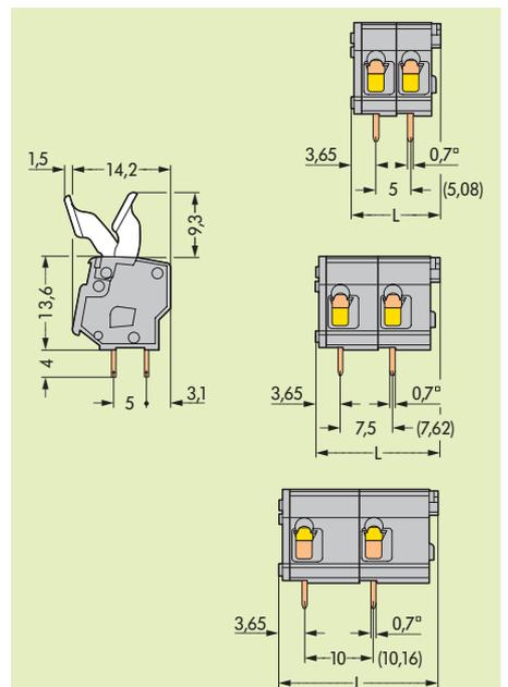
Диаметр отверстия под вывод:  $1.1^{+0.1}$  мм
