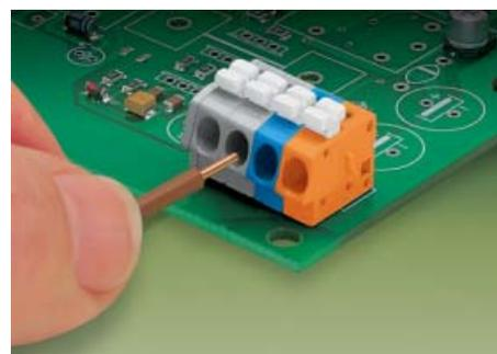
Подключение одножильного проводника:
