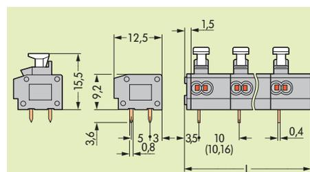
Диаметр отверстия под вывод: 1<sup>+0.1</sup> мм
