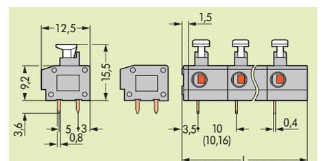
Диаметр отверстия под вывод: 1<sup>+0.1</sup> мм
