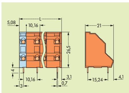
$$L = (\text{Число клемм} - 1) \times \text{Шаг выводов} + 5.08 \text{ мм} + 1 \text{ мм}$$
