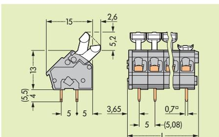
Диаметр отверстия под вывод: 1.1<sup>+0.1</sup> мм
