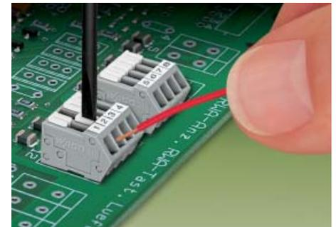
Подключение проводников: открыть зажим с помощью отвертки или передвинуть задвижку к отверстию для проводника, вставить зачищенный проводник до отказа и передвинуть задвижку в исходное положение (можно также передвигать задвижку без инструмента, ногтем).
