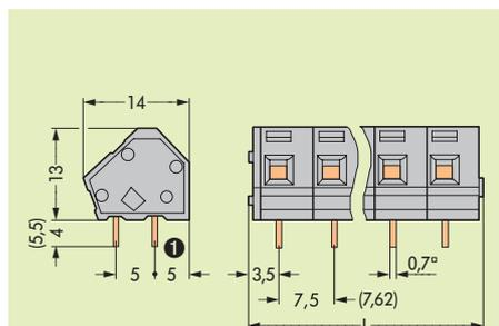
Диаметр отверстия под вывод:  $1.1^{+0.1}$  мм
