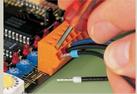
Подключение проводников - многожильный с обжимной трубчатой втулкой
