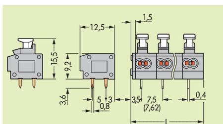
Диаметр отверстия под вывод: 1<sup>+0.1</sup> мм
