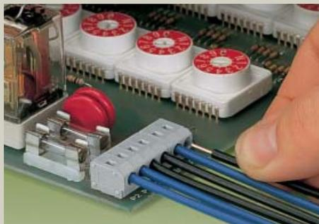
Подключение проводников без использования нажимной кнопки
