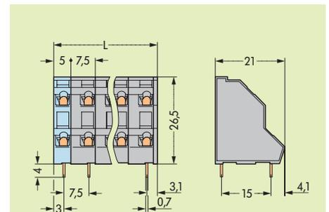
$$L = (\text{Число клемм} - 1) \times \text{Шаг выводов} + 5 \text{ мм} + 1 \text{ мм}$$
