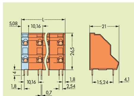
$$L = (\text{Число клемм} - 1) \times \text{Шаг выводов} + 5 \text{ мм} + 1 \text{ мм}$$
