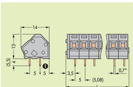
Диаметр отверстия под вывод:  $1.1^{+0.1}$  мм
