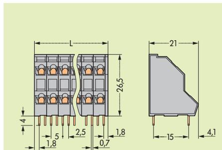
$$L = (\text{Число клемм} \times \text{Шаг выводов}) + 1 \text{ мм}$$
