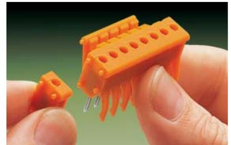
Сборка мультиштеккерной измерительной колодки
