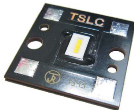
Рис. 12. Светодиодный модуль для фары головного света автомобиля на основе светодиодной продукции SemiLEDs
