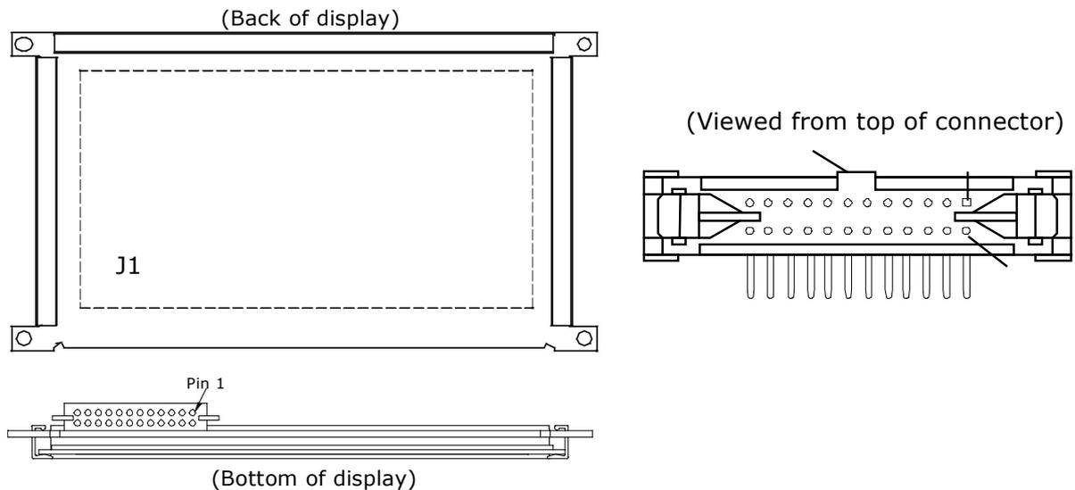
**Figure 2. Data/power connector – J1**
