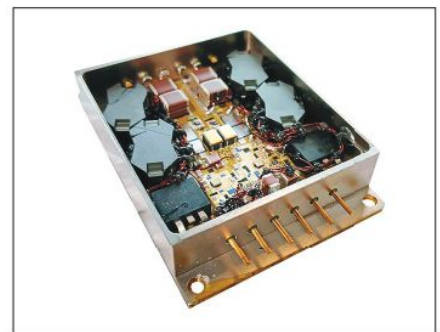
Рис. 2. Конструкция низкопрофильного гибридно-пленочного преобразователя напряжения повышенной мощности с явно выраженной плоской формой со снятой крышкой (промежуточный макетный образец)
