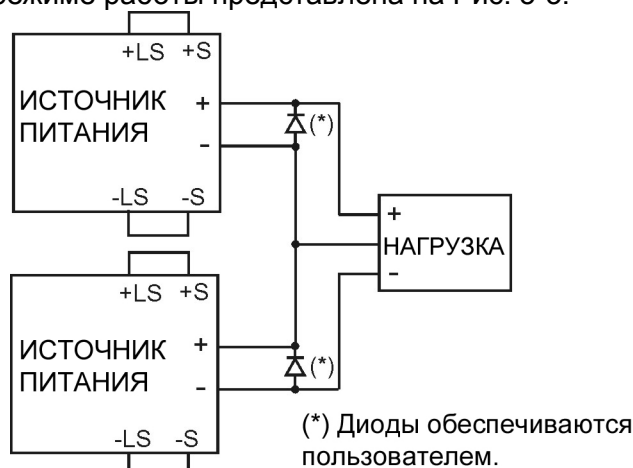
Рис.5-3: Последовательное соединение для получения положительного/отрицательного выходного напряжения
