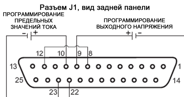
Рис.6-1: Подсоединение внешнего программирования уровнями напряжений
