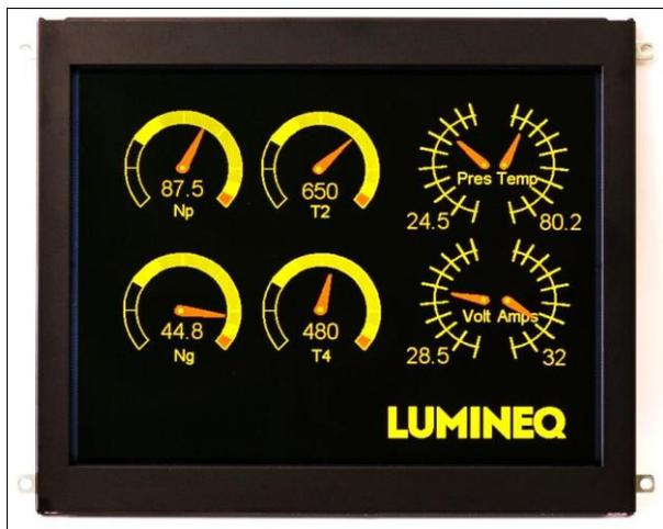
EL640.480-AA1 – многоцветный VGA-дисплей для эксплуатации в жёстких условиях.
